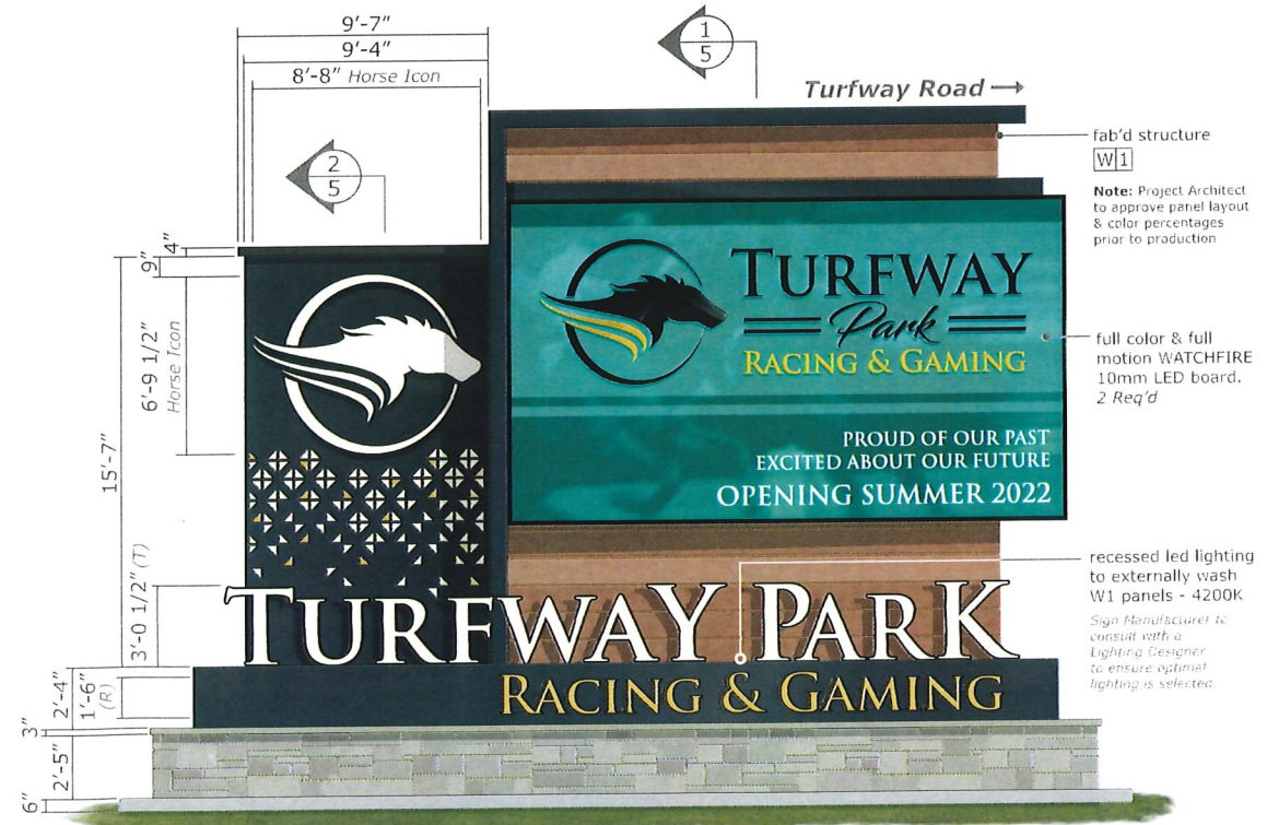
SIGN 1 | Elevation - A Scale: 1/8"=1'
